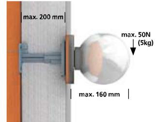
Bei der Wandmontage des Geräteträgers ist darauf zu achten, dass die Rohreinleitungen senkrecht ausgerichtet sind.
