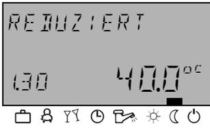
Die Betriebsart *REDUZIERT* bewirkt einen ständig reduzierten Heizbetrieb nach der vorgegebenen abgesenkten Raumtemperatur entsprechend der in den Heizkreisebenen eingestellten reduzierten Betriebsart ECO (frostgesicherter Abschaltbetrieb) bzw. ABS (Absenkbetrieb) unter Berücksichtigung der Minimaltemperaturbegrenzung des jeweiligen Heizkreises. Siehe Menü "Direktkreis bzw. Mischkreis-1 bzw. Mischkreis-2 - Parameter 1 = Reduzierter Betrieb" sowie "- Parameter 12 = Minimalbegrenzung".
