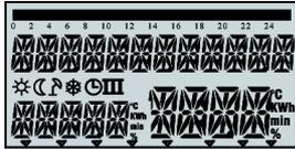
Bei Inbetriebnahme bzw. bei jeder Spannungs-Wiederkehr nach Netzausfall erscheinen vorübergehend alle im Display verfügbaren Segmente
