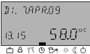
Im Automatikbetrieb stehen maximal 3 Zeitprogramme mit unterschiedlichen Heizbetriebszeiten zur Verfügung. Diese werden bei Inbetriebnahme als werkseitig festgelegte und unverlierbare Standardprogramme P1, P2 oder P3 aufgerufen und können bei Bedarf in der Schaltzeitenebene (siehe Menü "Schaltzeiten") mit eigenen Schaltzeiten überschrieben werden.
