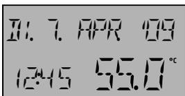
Sofern keine Fehlermeldung vorliegt, erscheint im Anschluss daran die Grundanzeige mit Datum, Uhrzeit und aktueller Temperatur des Wärmeerzeugers
