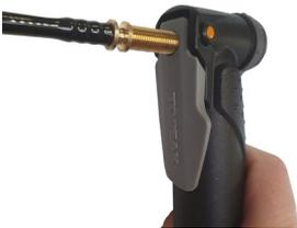
*Abb. 8: Druck ablassen*
