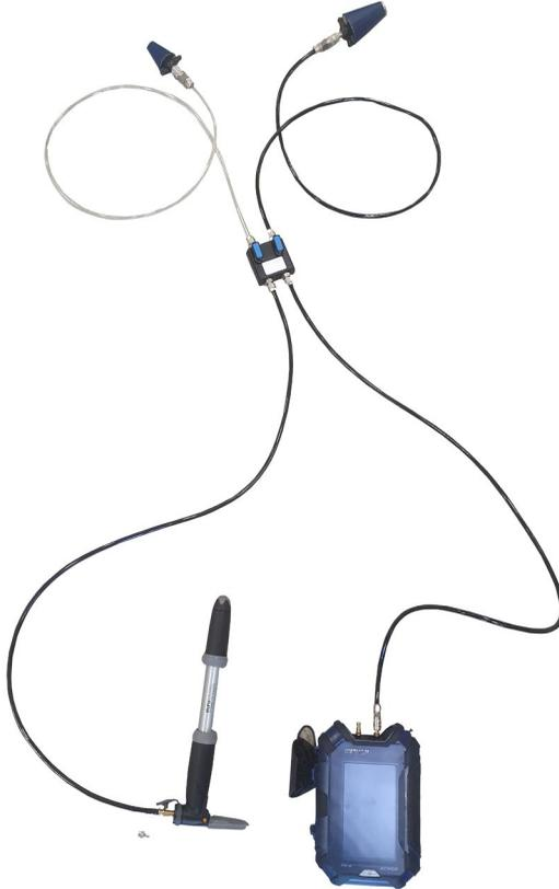
Abb. 10: Anschlüsse mit Absperrstopfen und Wöhler M 603
