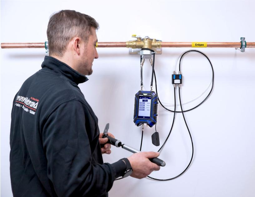
Abb. 9: Anschlüsse mit Einrohrzählerkappe und Wöhler M 603
