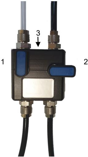
Abb. 4: Ventilblock mit Ventilhebeln (1 und 2) und Überdruckventil (3)
