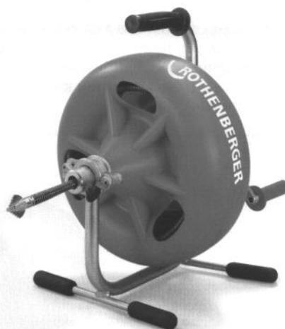
Lieferumfang (No. 7.2003): Hand-Rohrreinigungsgerät Typ 3 S (No. 7.2003), Spirale Ø 13 mm x 15 m (No. 7.2016), Kreuzblattbohrer Ø 35 mm (No. 7.2176) und Trennschlüssel (No. 7.2100)
