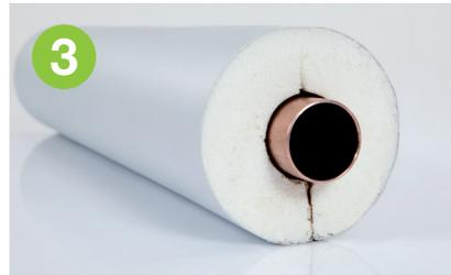
Zur Minimierung des Wärmeverlustes bei waagerechter Montage die Längsnaht so ausrichten, dass sich diese unten am Rohr (6.00 Uhr) befindet.\* Schalen-Querstöße zusätzlich mit passendem Klebeband sichern.
