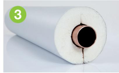
Zur Minimierung des Wärmeverlustes bei waagerechter Montage die Längsnaht so ausrichten, dass sich diese unten am Rohr (6.00 Uhr) befindet.\* Schalens-Querstöße zusätzlich mit passendem Klebeband sichern.
