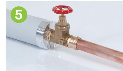
Der Abschluss des Rohrschalendes mit einer Endmanschette garantiert eine saubere Optik. Die Endmanschetten werden mit Hilfe eines Wickeldrahtes oder eines Klebebands auf der Rohrschale fixiert.
