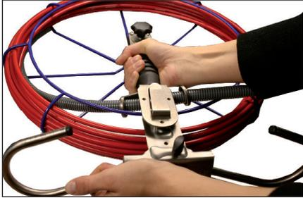
Zur Montage des Haspelfußes die Auflagefläche des Haspelfußes unter die Befestigungsfläche an der Koppelhalterung der Wöhler Handkehrhaspel schieben.
