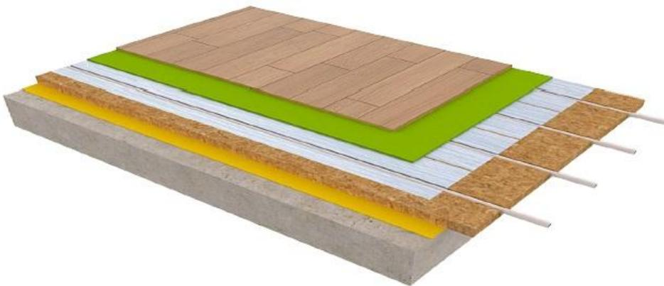
Kann ebenfalls bei Verwendung einer Dampfsolierung zwischen dem Beton und den Platten ETPF direkt auf dem Beton verlegt werden.
