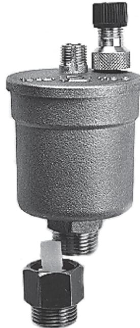
MINIVENT- automatischer Schnellentlüfter für geschlossene Warm- und Kaltwasseranlagen mit Temperaturen bis 115°C und Drücken bis 12 bar. Selbsttätiges Ent- und Belüften der Anlage beim Füllen, Entleeren und im Betrieb.
