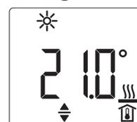
Die Standardanzeige wird dauerhaft angezeigt. Wenn Sie sich innerhalb des Menüs befinden und länger als 20 Sekunden keine Bedieneraktion ausführen, wechselt das Gerät automatisch zur Standardanzeige.
