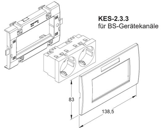
3. Anschlußleitungen verlegen und absetzen. Gerätekanaldeckel einsetzen und aufschieben, wenn nicht schon geschehen. Geräteeinbaueinheit oder alternativer Geräteinsatz anschließen.
