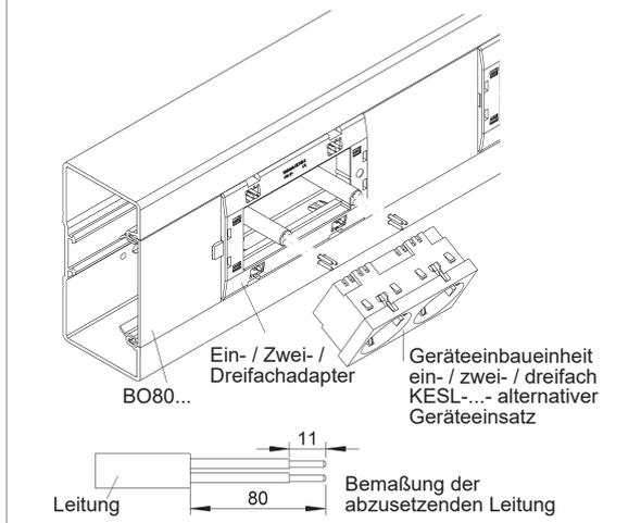
2. Die Verrastung mittels Schraubendreher im Uhrzeigersinn betätigen (optimal: Klingbreite 5-6 mm). Für eine Deckelmontage zwischen zwei Geräteeinbaueinheiten die Laschen an den vorhandenen Sollbruchstellen entfernen.
