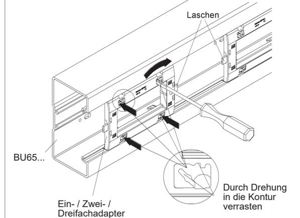
4. Geräteeinbaueinheit einrasten bzw. alternativer Geräteinsatz befestigen. Lochblende aufrasten.
