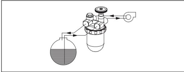
**„Oilpur Z A“ Zweistrangfilter mit Absperrung, Typ 2120:**
