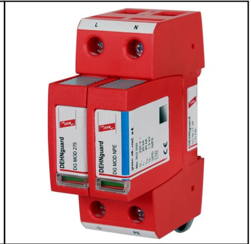
DG M TT 2P ... FM: Modularer Überspannungs-Ableiter für einphasige TT- und TN-Systeme (Schaltungsvariante "1+1"); mit potentialfreiem Fernmeldekontakt
