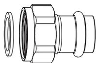
**Anschlussverschraubungen mit Pressnippel**
