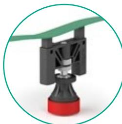
Die Ecktraverse MR SF ermöglicht es, den höhenverstellbaren Wannenuß flexibel in der Ecke anzubringen, z. B. in Einbausituationen, bei denen der Ablauf senkrecht in der Ecke verläuft. Sie ist Bestandteil der Montagerahmen SF sowie einzeln als Zubehör erhältlich.
