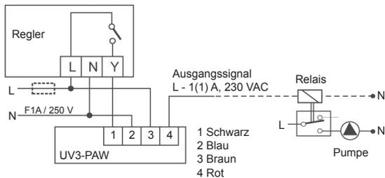
Das Ventil ist werksseitig mit einem Ausgangssignal in der Position B-AB eingestellt. Wenn Sie den Stellmotor um  $90^\circ$  drehen, ist das Ausgangssignal in Position A-AB (siehe Schema: Montage des Stellmotors auf das Ventil und Ausgangssignal)
