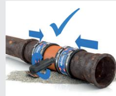
Die Schlauchadapter wieder zurück über beide Rohre schieben, bis die Mittellippe im Adapter zwischen den Rohren einrastet. Schellenbänder mit dem nötigen Anzugsdrehmoment festziehen, fertig!
