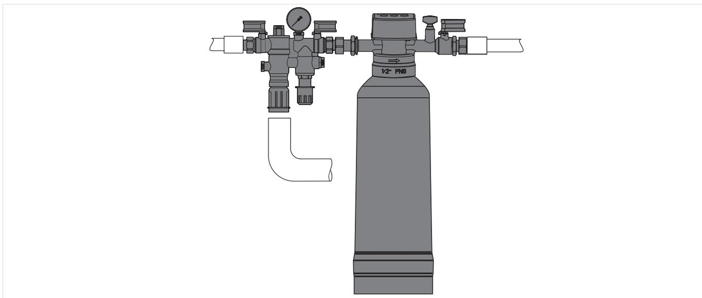
Abb. 1 Beispiel für den standardmäßigen Einbau der Nachfüllkombination
