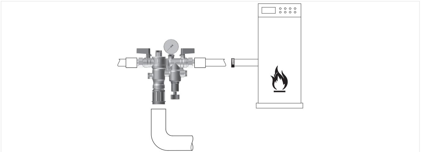
Abb. 1 Beispiel für den standardmäßigen Einbau der Nachfüllkombination
