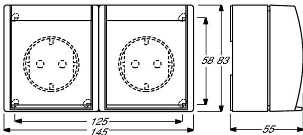
ocean® 2-fach waagrecht SCHUKO® Steckdosen mit Bohrmaßen
