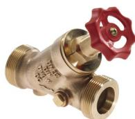
**Rotguss Freistromventil Typ 3506** nach DIN EN 1213, Werkstoff nach DIN 50930, Teil 6 bzw. UBA Liste 03/2017, Außengewinde, nichtsteigendes sowie tottraumfreies
