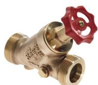
**Rotguss KFR - Ventil Typ 3606** nach DIN EN 13959, Werkstoff nach DIN 50930, Teil 6 bzw. UBA Liste 03/2017, Außengewinde, nichtsteigendes sowie tottraumfreies
