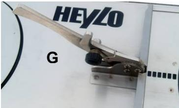
Dann wird der Spannhebel (G) in 90° zur Einheit aufgestellt. Das System ist jetzt entspannt und kann grob in der Tür justiert werden. **Die Seite mit dem Spannhebel zeigt dabei zum Schwarzbereich.**
