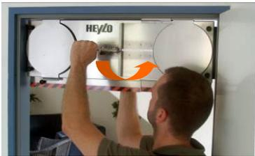
Mit dem Spannen des Spannhefles (G) wird die Einheit fest in der Tür fixiert.
